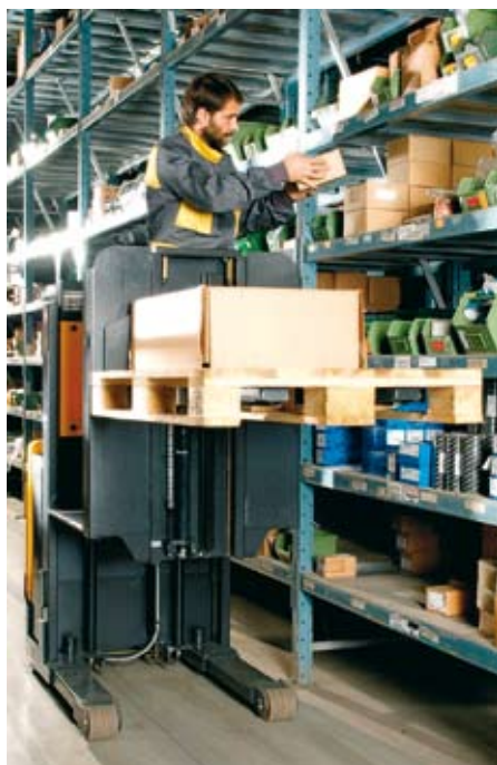
OM XOP07ac mit einem unabhängigen Zusatzhub für bequemes Entnehmen und Ablegen des Pickgutes
