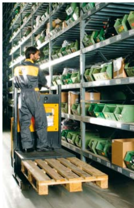
Der XOP07ac lässt sich bei einer auf 120 cm angehobenen Bedienerplattform noch fahren
