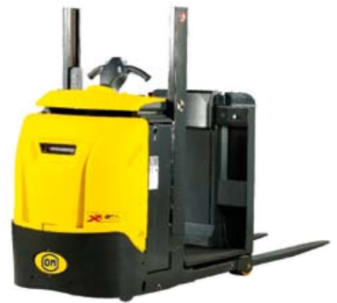
Der XOP07ac Kommissionierer mit einer Tragkraft von 700 kg bei einem Lastschwerpunkt von 600 mm
