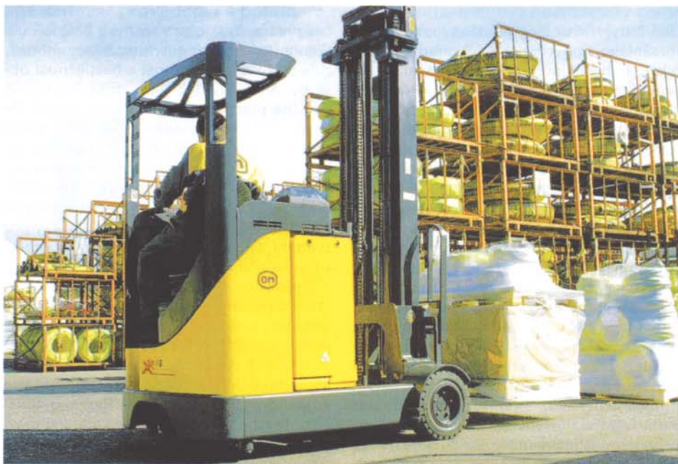
Nový vozík s výsuvným výložníkem lze flexibilně využívat jak v interiéru, tak i venku
