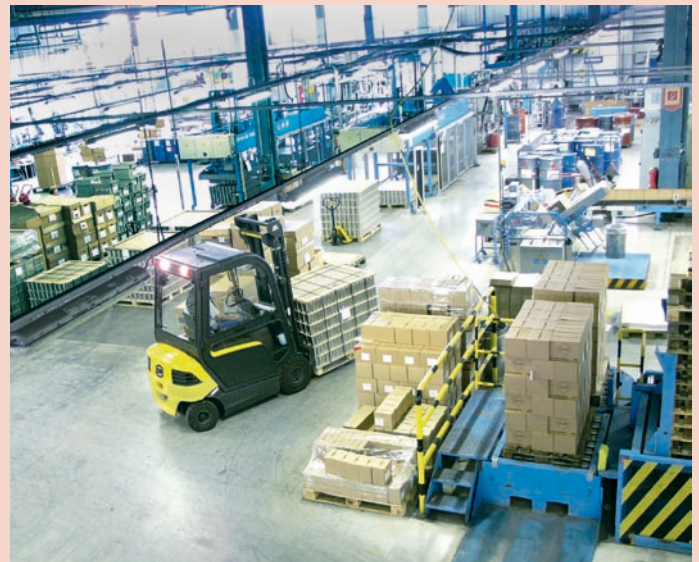
Bild 3: Am Ende der Produktionslinie gelangen die Kartons zur automatischen Palettieranlage und werden dort von XE20ac Elektro staplern übernommen
