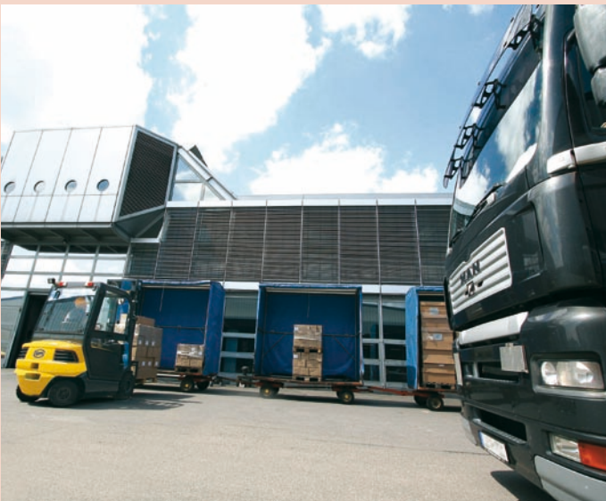
Bild 2: Mit einem Elektro stapler werden die Waggonen beladen und anschließend mit 20 km/h auf der Express-Strecke um die Werkshallen gezogen
