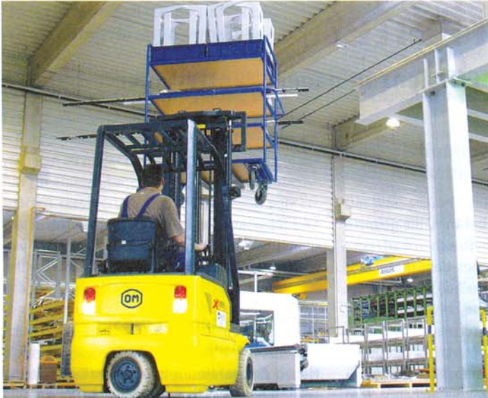
2: Stapler mit minimiertem Wendekreis heben Teile auf die zweigeschossige Bühnenanlage
