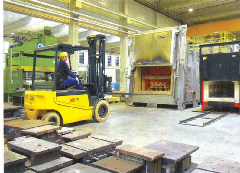
3: Mit verlängerten Gabelschuhen sind die Schwerlaststapler für das Handling der tonnenschweren Werkzeuge vor der Ofenanlage gewappnet
