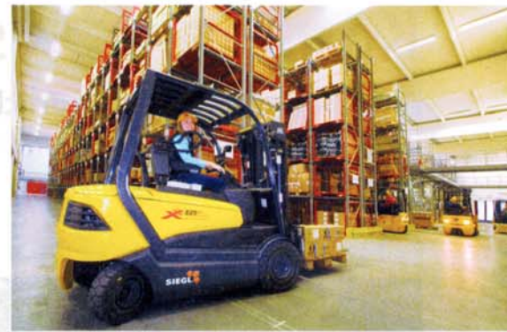
Bild 2: Elektro stapler im Bereitstellungsbereich des HRLs
