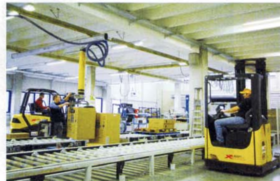
Bild 3: Elektro stapler und Schubmaststapler an der Rollenförderanlage im Warenausgang
