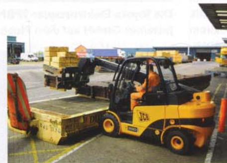
Die Paletten können in die hintere Position teleskopiert werden
