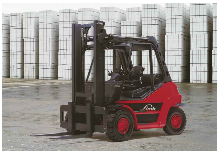
Der H60 ist ein hydrostatischer Verbrennerstapler von Linde Material Handling mit einer Tragkraft von sechs Tonnen
