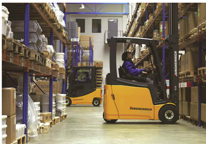
Der Jungheinrich-Elektrostapler mit Drehstrommotor mit niedrigem Verbrauch bei gleichzeitig hohem Wirkungsgrad
