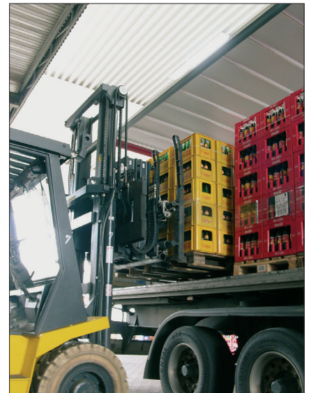
E 60N dominieren das Palettenhandling mit Doppelgreifereinheit für zwei Paletten.
