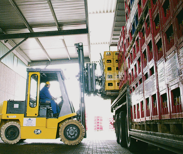
E 60N-Stapler am 42 Paletten fassenden Coca- Cola-Jumbotruk.
