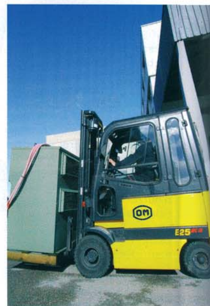
Der XE25ac zählt mit einer Spitzen-Fahrgeschwindigkeit von 20 km/h zu den Schnellsten seiner Klasse. (Bilder: OM)
