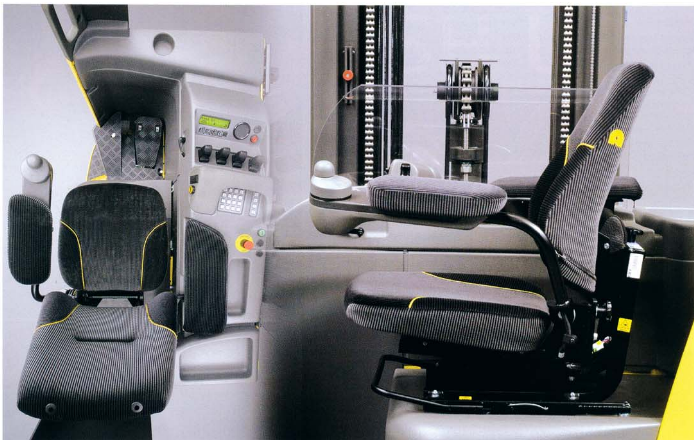
Ein Fahrersitz nach Maß – neigbare Rückenlehne, Minilenkrad, Bordcomputer, verstellbare Bedienkonsole, beste Rundumsicht, verstellbare Armlehne und größtmögliche Beinfreiheit
