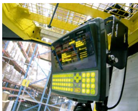
Die Kommissionierstapler XOP3 sind mit Datenterminals zur schnellen Kommunikation und Handskannern ausgerüstet
