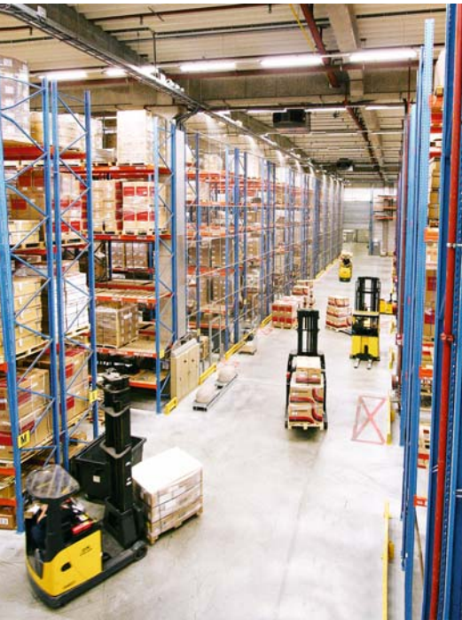
XRac und XOP in multifunktionellen Einsätzen für Transport sowie Ein- und Auslagern der Paletten im HRL
