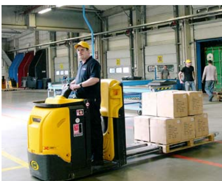
Der Kommissionierstapler XLOGOac mit langen Gabeln transportiert mit Höchstgeschwindigkeit auch zwei Paletten
