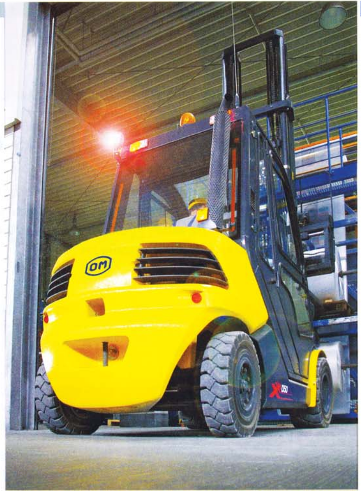
Die XD-Staplerflotte von OM ist für Traglasten von 4 bis 10 t ausgelegt und besitzt eine vollständig gedämpfte Kabine Bild: OM
