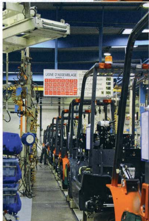
Toyota setzt auf einen Mix aus japanischer Tradition und effizienter Produktionstechnik. Im französischen Ancenis werden die Gabelstapler für Europa gebaut. Probleme in der Fertigung werden mit Hilfe der so genannten Andon-Tafeln auf der Stelle gelöst
