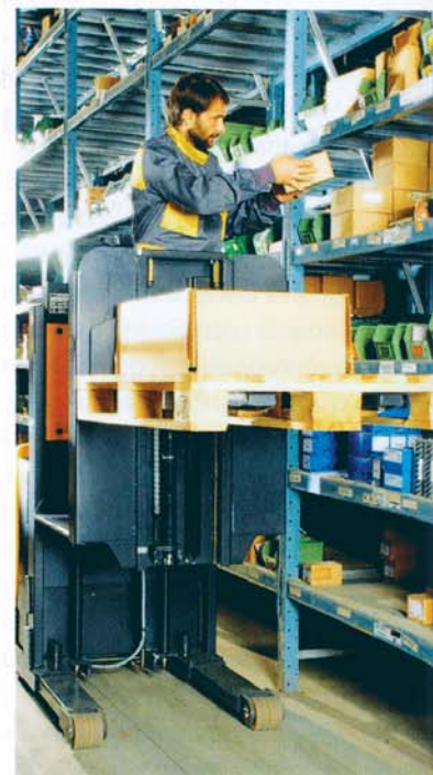
Picken ohne Reue: Dank eines unabhängigen Zusatzhubes kann der Anwender bequem in 3 m Höhe arbeiten, ohne dass dabei der Rücken zu Schaden kommt Bild: OM
