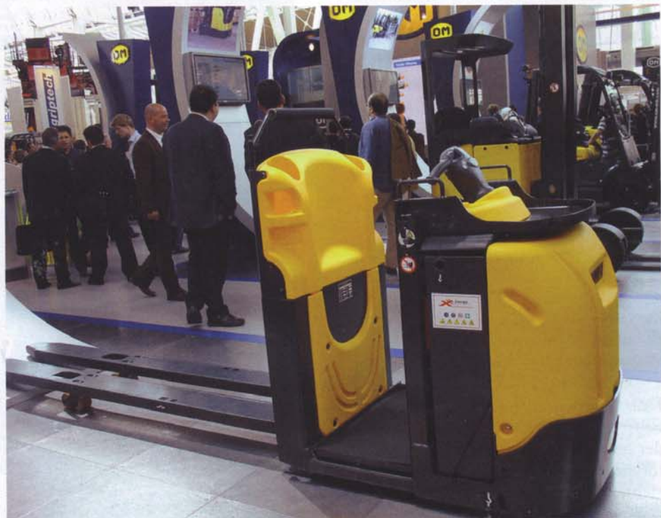
Bild 7 Die gelben Teile des OM-Kommissioniers XLogo ac sind aus speziellem Kunststoff, der sich wieder zurück in seine Ausgangsposition „beult“.
