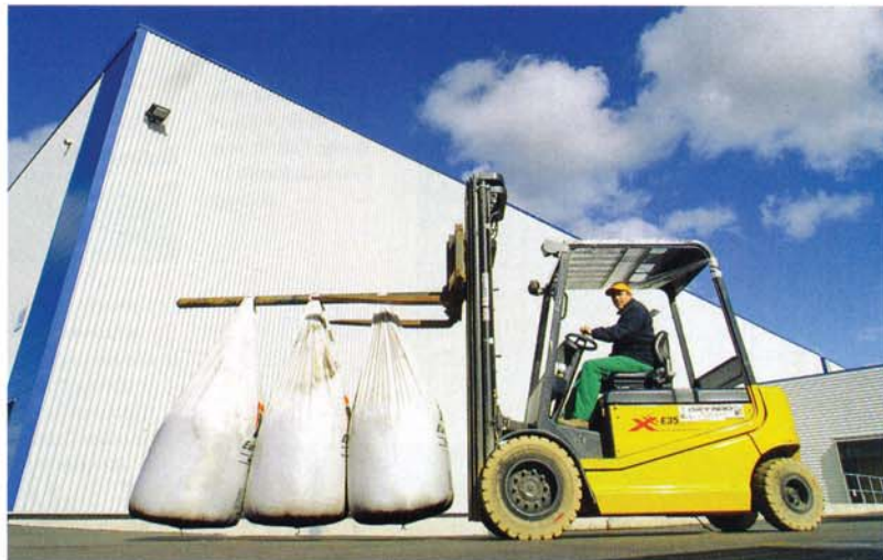
XE35 Elektrosta- pler mit Trage- Dorn für bis zu 3 „Bigbag's“ mit jeweils 500 kg Gewicht.
