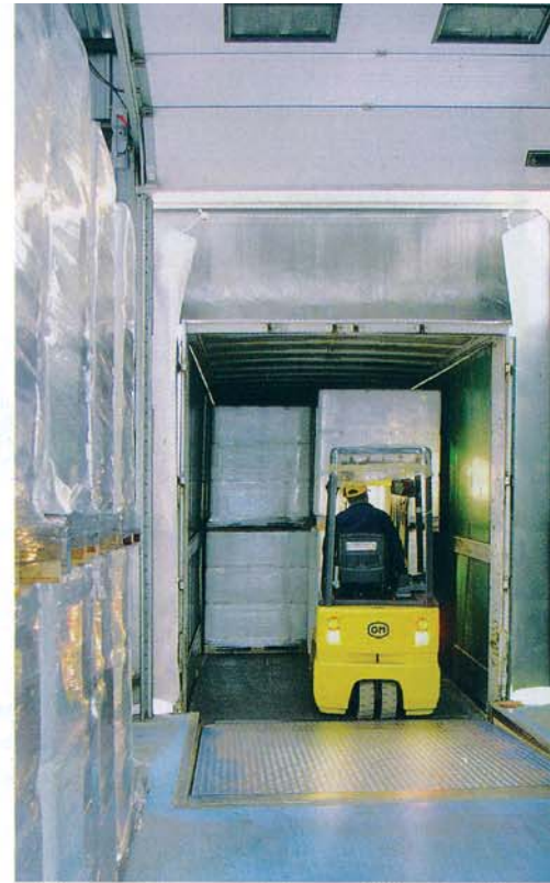
XE-Elektrostapler beim Verladen von Kunststoff-Behältnissen am LKW Terminal (Groupe Roullier, Dinard).
