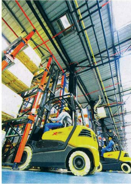
XEac-Elektrostapler beim Einlagern in Einfahr-Regale im Warenlager von Agriplas (Groupe Roullier, Dinard).
