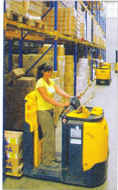
Kommissionierstapler für ‚Picken‘ und Fahren mit AC-Technik.
