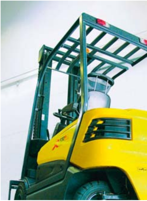
Rangieren auf engstem Raum: Die spezielle Konstruktion erlaubt ein Drehen des Staplers um die eigene Achse.
