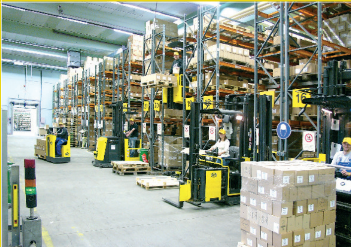
Im HRL-Bereitstellungsbereich bewältigen 9 OM Hochregalstapler in man up-Version die Kommissionier- und Einlagerungsarbeiten.
