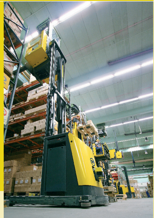
Die fünf XOP2 Elektro-Hochhub-Kommissionierstapler in man up-Version sind mit Zusatzhub für bequemes „Picken“ ausgestattet.
