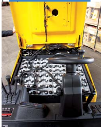
Compartiment bien rempli de la batterie de 80 volts
