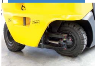
Angle de braquage de l'essieu directeur, roues à l'intérieur du carénage
