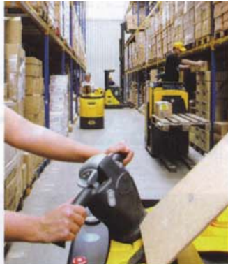
Mit wendigen Niederhub-Kommissionierern XLOGOac lassen sich schnelle Kommissioniervorgänge aus den unteren Regalebenen durchführen
