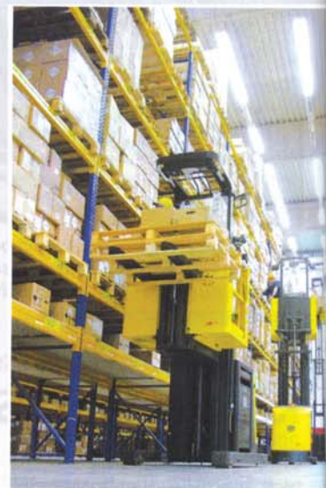
Die Bediener der drei Hochhub-Kommissionierstapler XOP können eine Greifhöhe von 12 m erreichen
