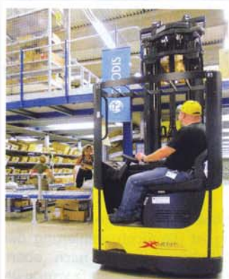
Schubmaststapler XR14ac heben die Paletten auf die zweistöckige Kommissionierbühne
