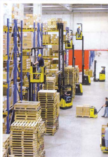
Im Flottenverband: Schubmaststapler XR14ac befüllen das HRL, Elektro-Nieder- und Hochhubwagen agieren in den Bereitstellungsbereichen davor
