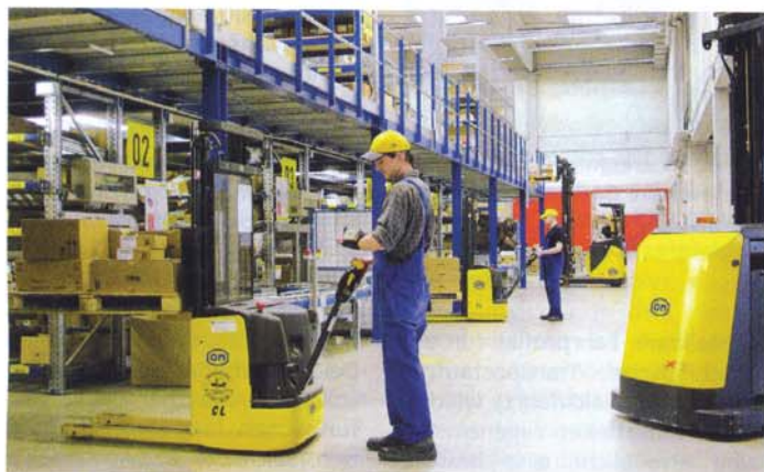
Nachschub rollt mit Elektro-Hochhubwagen CL zur Pick-by-Light-Anlage
