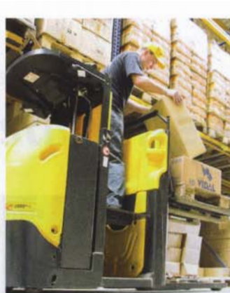
Die hebbare Bedienerplattform des XLOGO ermöglicht ein bequemes Kommissionieren
