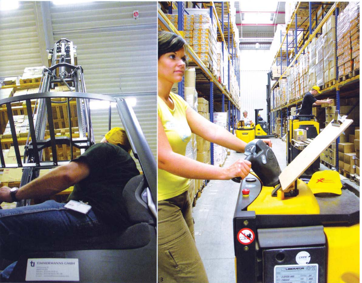
1 In den Hochregallager-Bereichen von Geodis in Duisburg sorgen XR14ac-Schubmaststapler von OM für das sichere und schnelle Ein- und Auslagern der Paletten. 2 Das Cockpit gewährleistet die optimale Sicht nach oben. 3 Ebenfalls bei Geodis im Einsatz: der wendige XLOGOac-Niederhub-Kommissionierer.
