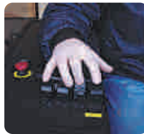
De bedieningsschakelaars zijn te groot; de armleuning had wat breder gemogen
