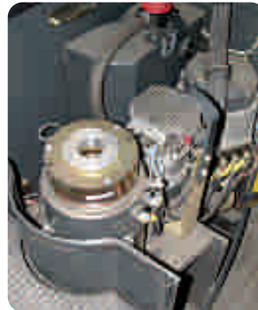
De wisselstroomaandrijving komt uit de Still-stal
