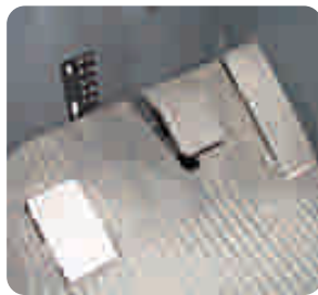
De vloerplaat, met van links naar rechts de dodemansschakelaar, het rem- en het rijpedaal, is elektrisch verstelbaar
