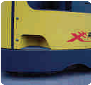
De opstap is hoog, de uitsparing heeft geen functie bij het uitstappen.
