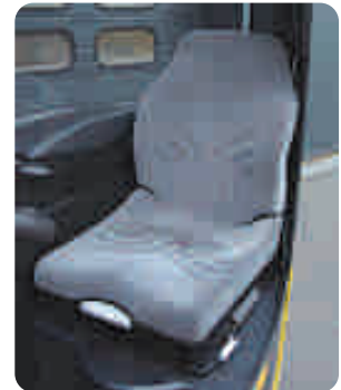
De rugleuning van de Grammer MSG20 stoel kantelt mee met de ruime lengteverstelling
