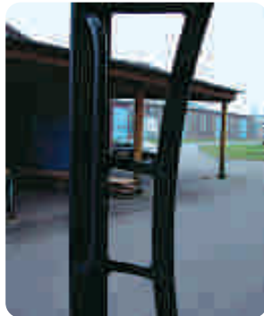
De drie doorkijkvensters in de linker voorstijl geven een betere kijk op de werkomgeving
