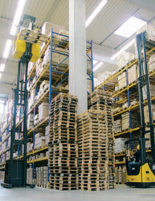
Das Zusammenspiel von XR14ac-Schubmaststaplern beim Einlagern und XOP-Hochhub-Kommissionierstapler bei der Warenentnahme optimieren die Prozesse im Paletten-HRL.
