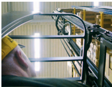
XLOGO-Niederhub-Kommissionier erlauben das Picken bei Gegenverkehr in engen Regalgassen. Bilder: Pronovas
