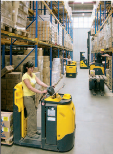
Mit wendigen XLOGOac Niederhub-Kommissionierern lassen sich schnelle Kommissioniervorgänge aus den unteren Regalebene durchföhren.
