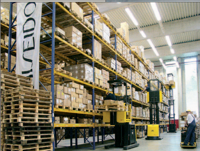
Die Bediener von drei XOP Hochhub-Kommissionierstaplern können bis auf eine Greifhöhe von 12 m arbeiten.
