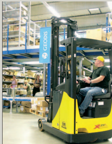
XR14ac-Schubmaststapler heben die Paletten auf die zweistöckige Kommissionierbühne.
