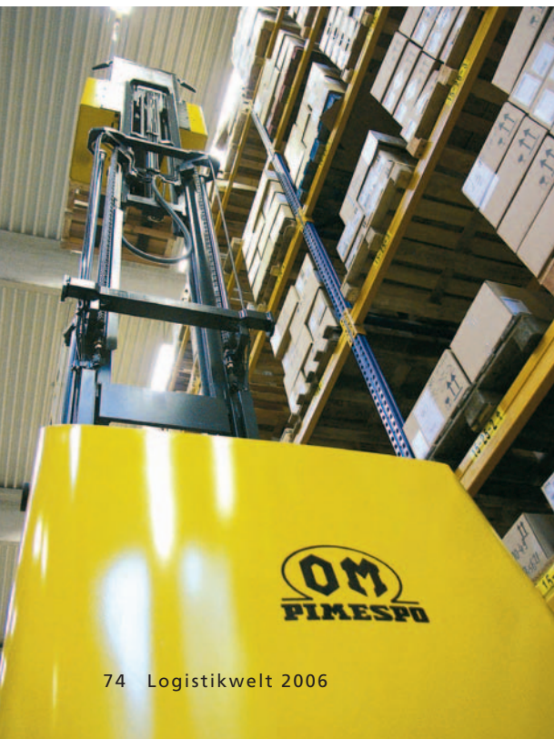
Mit dem XOP-Kommissionierstapler erreicht der Bediener alle Regalebenen des HRL.
