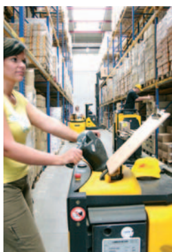
XLOGO-Niederhub-Kommissionier erlauben das Picken bei Gegenverkehr in engen Regalgassen. Bilder: Pronovas
