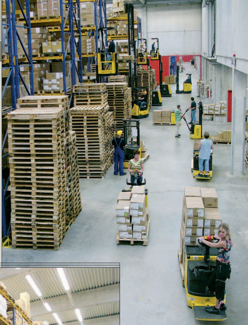
OM-Flottenverband bei Geodis: XR14ac-Schubmaststapler befüllen das HRL. Elektro-Nieder- und Hochhubwagen agieren in den Bereitstellungsbererichen davor.
