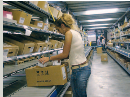
Die „Pick-by-Light“-Anlage ist mit vier Produktebenen ausgestattet. Die Befüllung der Regale mit „Nachschub“ geschieht regalrückseitig.
