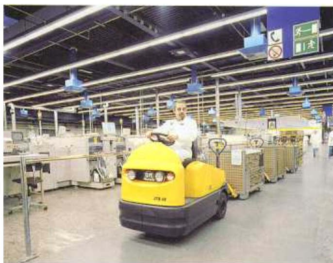
Die CTR 60-Elektroschlepper ziehen bis zu fünf Wagons
