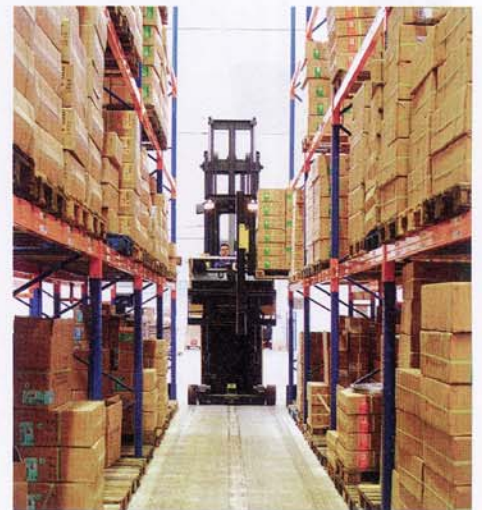
Bild 3: Induktiv geführte Schmalgangstapler sichern den schnellen Warenumschlag im Hochregallager
