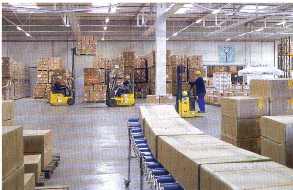
Im Wareneingangspuffer übernehmen XE-Dreiradstapler sowie CT-X 14 Deichselhochhubwagen mit Fahrerplattform den Transport
