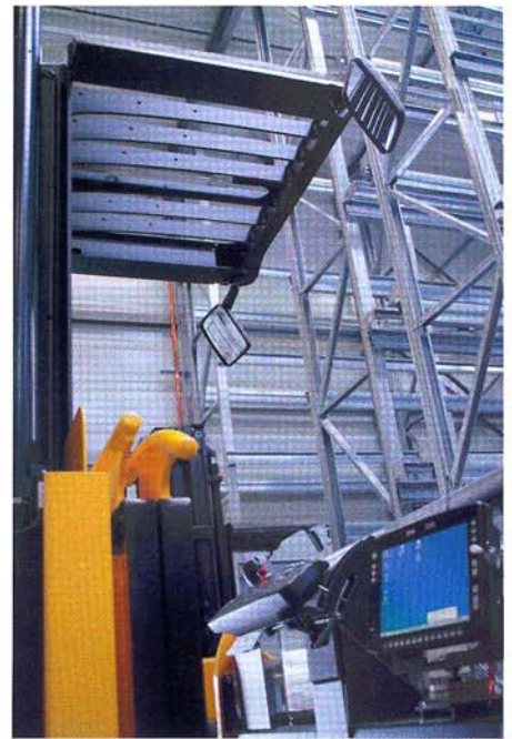
Für die Übermittlung der Auftragsdaten ist das übersichtliche Fahrercockpit des Dual 15-3 Man Up-Hochregalstaplers von OM Pimespo mit einem modernen Monitor ausgestattet.
