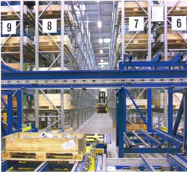
Vor einer Regalgasse: auf zwei Etagen fördernde Anlage für unterschiedliche Aufgaben.
