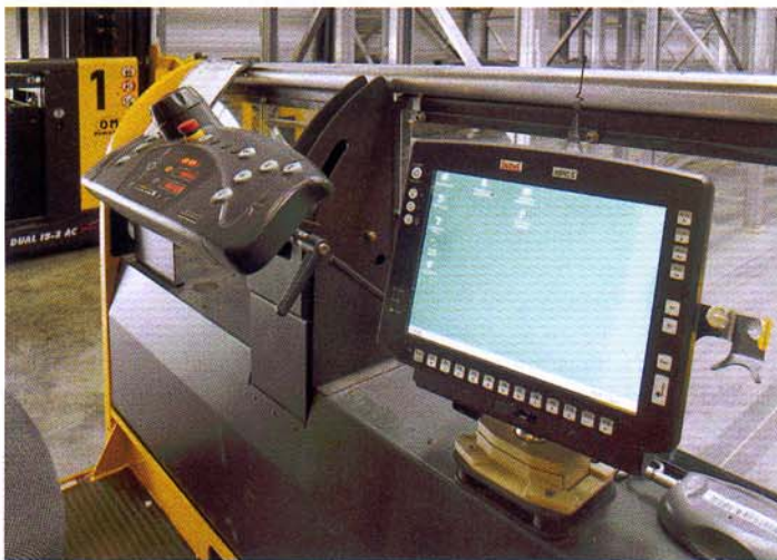
Blick in das Hochregalstapler-Cockpit mit ergonomischer Tastatur und Monitor zur Online-Autragbearbeitung
