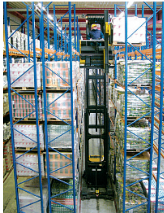
Bild 2: Durch Individual-Konfiguration ist der XNA_ac mit einer Tragkraft von 1000 kg, einer Hubhöhe von 8000 mm und einer Maximalbelastung für 13-Stunden-Schichten ausgelegt
