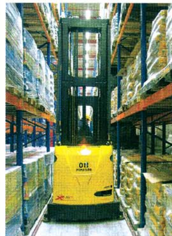
Für hallenübergreifende Einsätze wurde in Abstimmung mit dem Betreiber ein XNA_ac mit besonders niedriger Bauart konfiguriert
