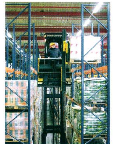
Die Bediener können die Bewegungsvorgänge stets in direktem Blickfeld auf Augenhöhe kontrollieren
