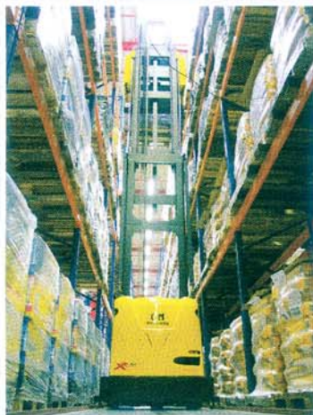
Die Schienenführung des Xnaac erlaubt schnelle Fahrbewegungen innerhalb der Hochregallager-Gassen
