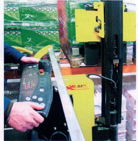
Der Bediener nimmt die Feinabstimmung von Hub- und Senk vorgängen sowie horizontales Drehen der Paletten durch Zusatzhub vor.
