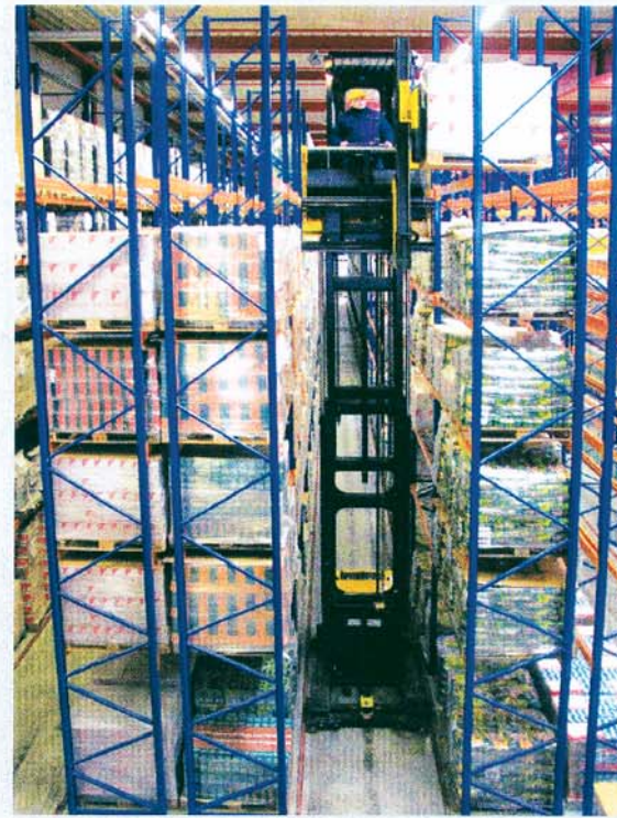
Bild 2: Durch Individual-Konfiguration ist der XNA_ac mit einer Tragkraft von 1000 kg, einer Hubhöhe von 8000 mm und einer Maximalbelastung für 13-Stunden-Schichten ausgelegt
