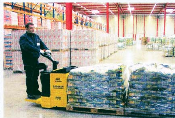
Bild 3: TSX 20 Niederhubwagen mit doppelter Gabellänge nehmen zwei Paletten hintereinander auf und fahren mit IntelliDrive Spitzengeschwindigkeiten von über 10 km/h
