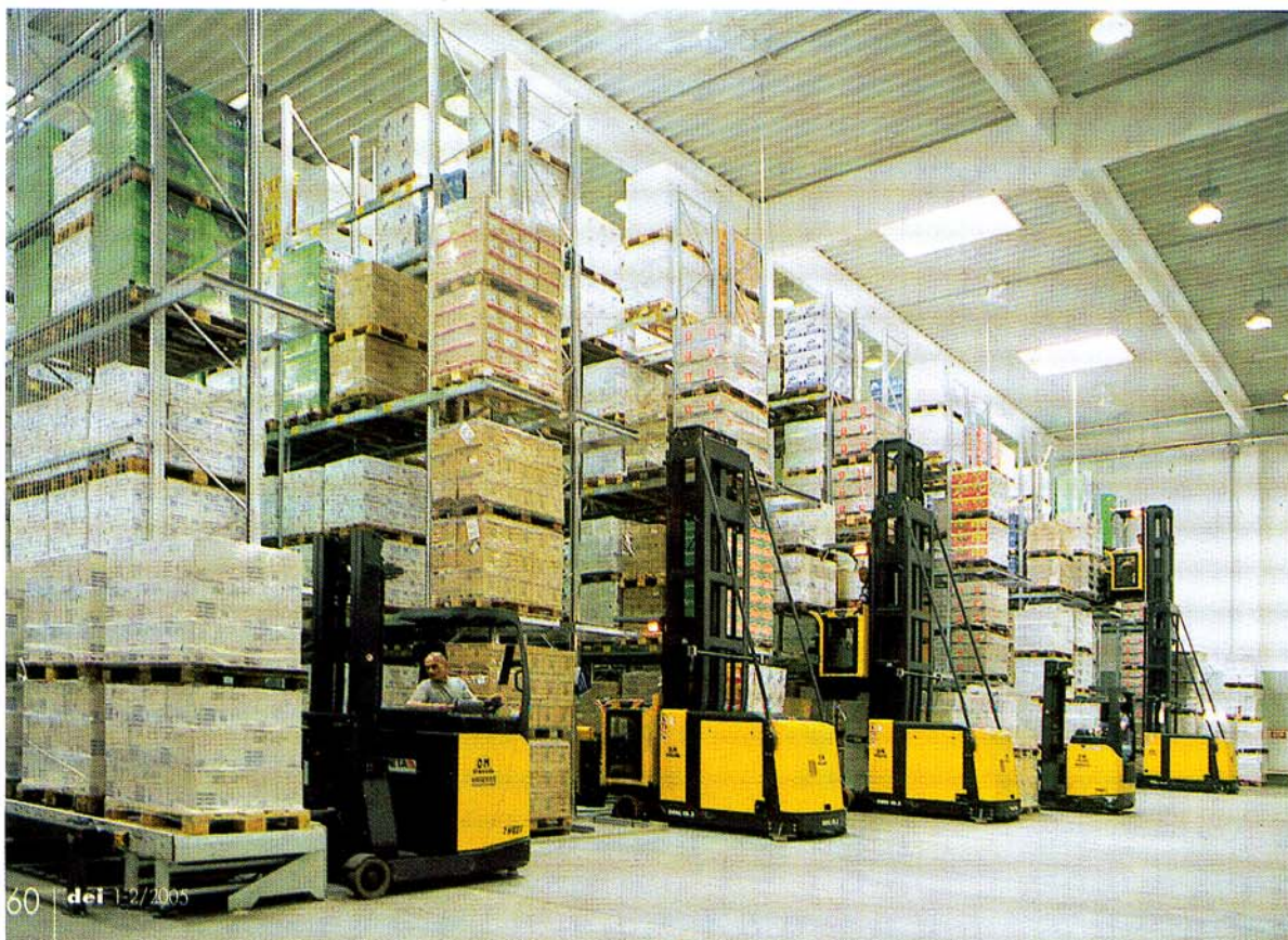
Im Einsatz: Flurförderzeuge von OM Pimespo zwischen den beiden Hochregallagerbereichen
