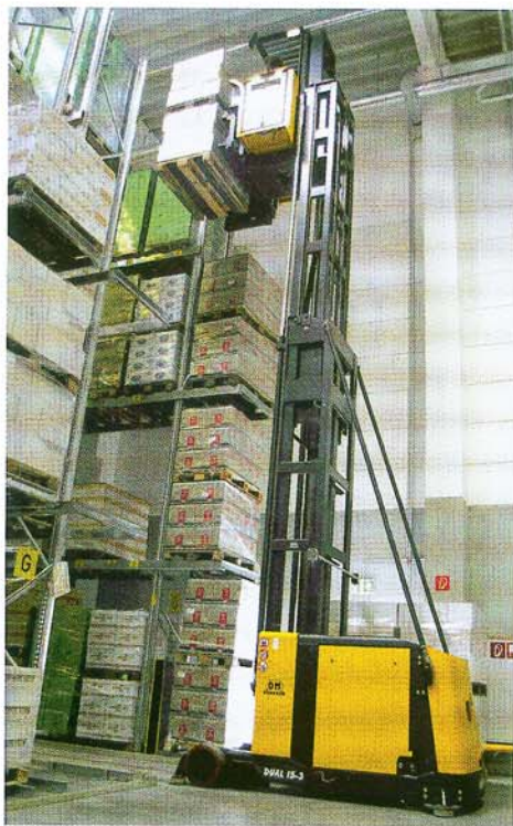
Sensorgesichertes Einfahren eines Dual-Hochregalstaplers in die Regalgasse
