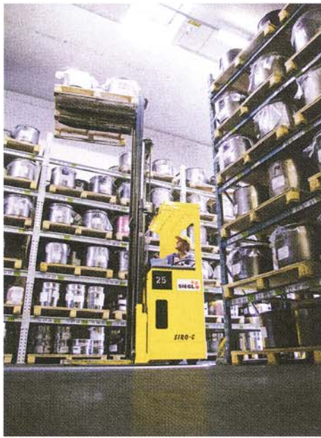
Paletten mit Flüssigkomponenten nimmt der Hochhubwagen Siro C auf
