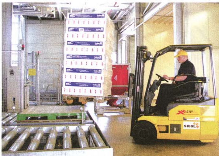
Elektrostapler XE 15 übernehmen die Paletten von den Satelliten-Paletten des Durchlaufregallagers zur Lkw-Beladung
