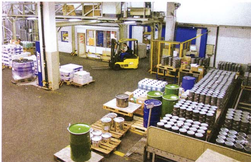
Von der Abfüllanlage rollen die Dosenpaletten zur Hebeanlage und weiter zum automatischen Dosenlager
