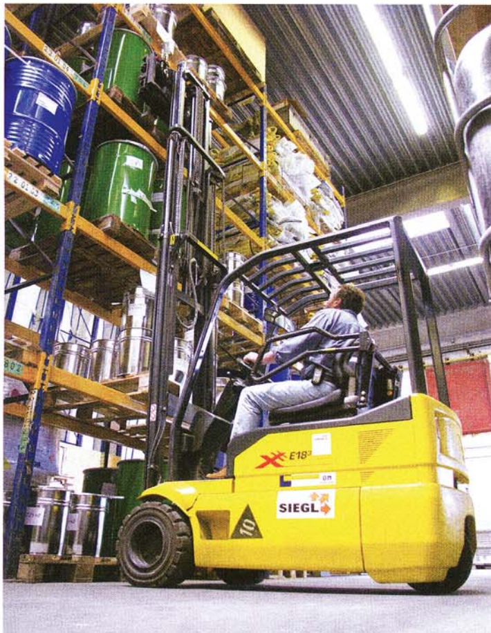
Im Rohstofflager übernehmen Elektrostacker XE 18 von OM-Pimespo das Palettenhandling beim Ein- und Auslagern
