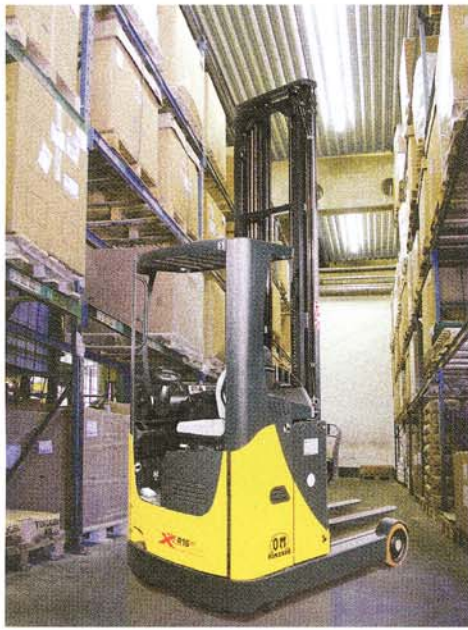
Der neue Schubmaststapler XRac stapelt in Höhen bis zu 11,5 m
