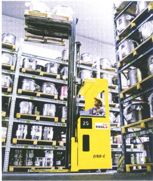
4 Hochhubwagen Siro C mit Fahrersitz beim Auslagern von Gebinden aus dem Komponentenlager für Flüssigrohstoffe
