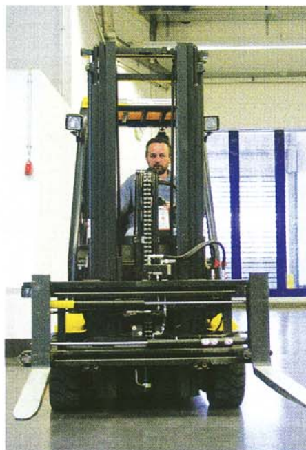
2 Bedarfsgerecht: die XE-Stapler sind mit einer automatischen Zinkenverstellung ausgerüstet
