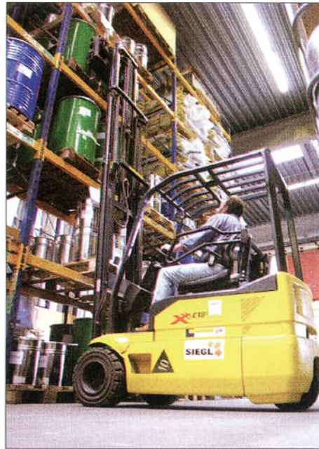
Im Rohstofflager übernehmen XE 18 3 Elektrostapler von OM-Pimespo das Palettenhandling beim Ein- und Auslagern – sicher und präzise bis auf die sechste Palettenregalebene.
