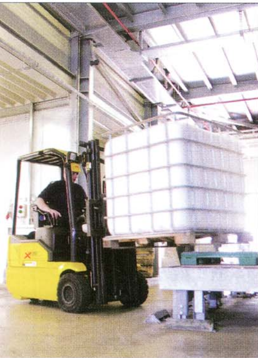
Von den Auslagerungsplätzen des Durchlaufregallagers (DRL) übernehmen XE 15 3 Stapler die schweren Lasten zur Verladung.
