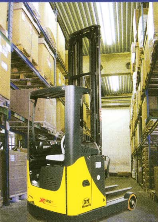
Die Paletten mit Flüssigkomponenten nimmt sicher der Siro-C-Hochhubwagen auf die Gabel.
