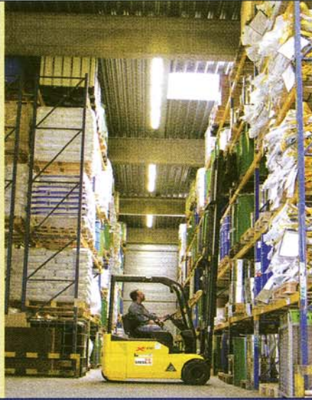
Im Rohstofflager übernehmen XE 18 3 -Elektrostapler von OM Pimespo das Palettenhandling beim Ein- und Auslagern.
