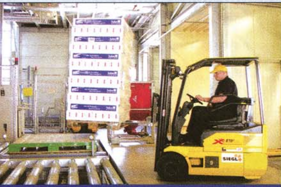
Die XE 15 3 -Stapler übernehmen die Paletten von den Satelliten-Paletten des DRL zur Lkw-Beladung.
