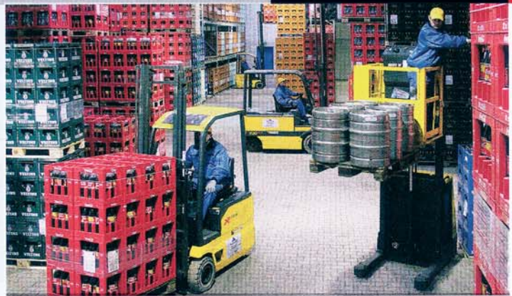
Beim Zusammenstellen der Kommissionen (li.) wird die OM-Staplerflotte von Vertikalkommissionierern des Typs XOP1 unterstützt.
