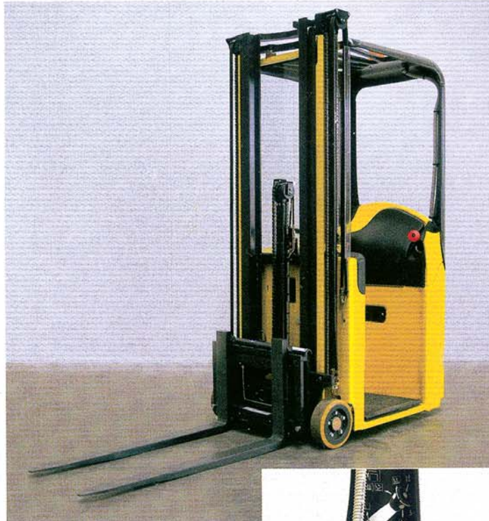
Die Wendigkeit des Gerätes wurde durch reduzierte Maße und die Achsverlagerung vor das Hubgerüst optimiert
