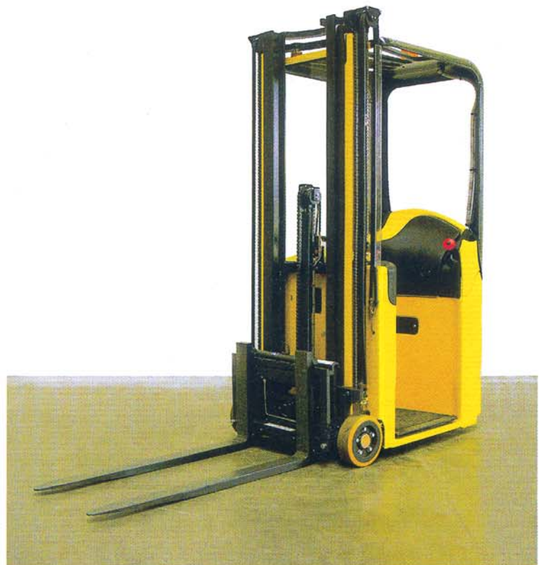
Klare Konzeption: Ein Standgabelstapler mit Gegengewicht – die Zahl der Wettbewerber ist äußerst überschaubar und der Einsatzbereich sehr vielfältig
