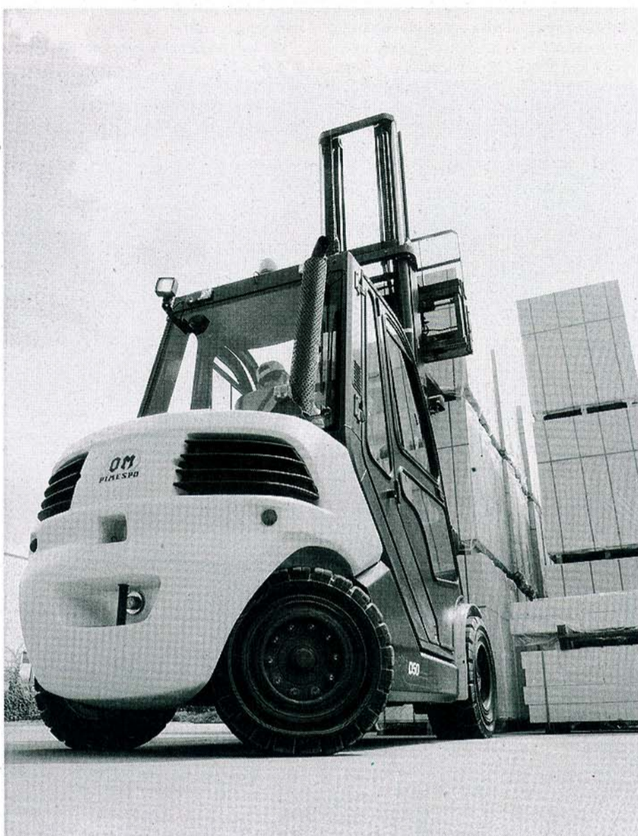
XD50 mit minimiertem Wendekreis für Staplerarbeiten unter eingeschränkten Platzverhältnissen. Fotos: OM
