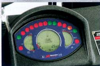
Das übersichtliche LCD-Display am Fahrerarbeitsplatz zeigt alle relevanten Fahrzeugdaten an (Bilder: Pronovas)
