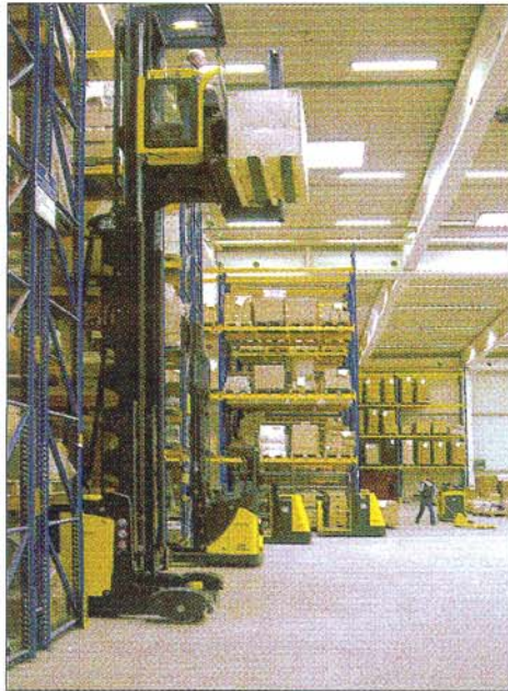
Palettenübergabezone von XRac-Schubmaststapler zum neuen XNA_ac-Hochregal-Schmalgangstapler.
