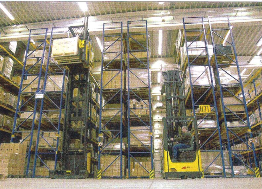
Bereitstellungsbereich der Paletten für XNA_ac Schmalgangstapler zur Ein- und Auslagerung im HRL.
