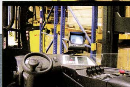
XRac-Cockpit mit Monitor für die Bildübertragung von der Hubgabelkamera zur genauen Palettenpositionierung.
