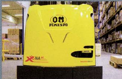
Sensor der PSA des XNA_ac sind in der Heckabdeckhaube formschön integriert.
