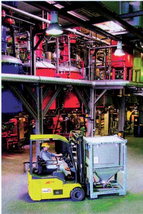
Herzstück der Buntfarbenproduktion ist die automatische Fertigungsline. XE-Stapler heben und fahren die befüllten Metallcontainer
