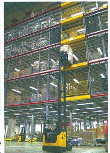
THESI-Schubmaststapler in der Aktionszone vor der 6-geschossigen Bühnenanlage.
