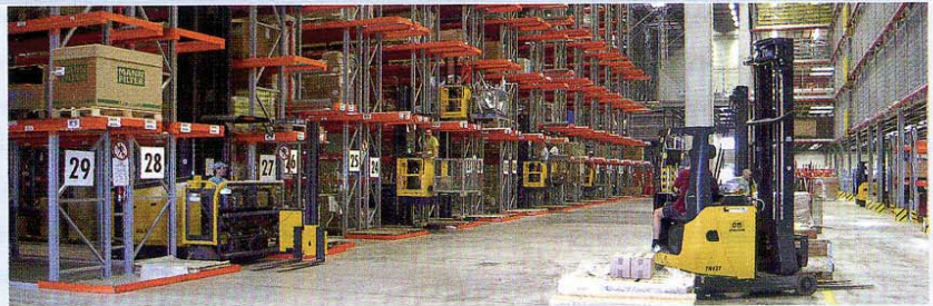
▲ Zwischendeck für Warenkontrolle und Erfassung vor dem Einlagern. Warenbewegungen der Kleinteile mit Rollenbahnen, Gitterboxen mit CI-Hochhubwagen und TI-Niederhubwagen.
