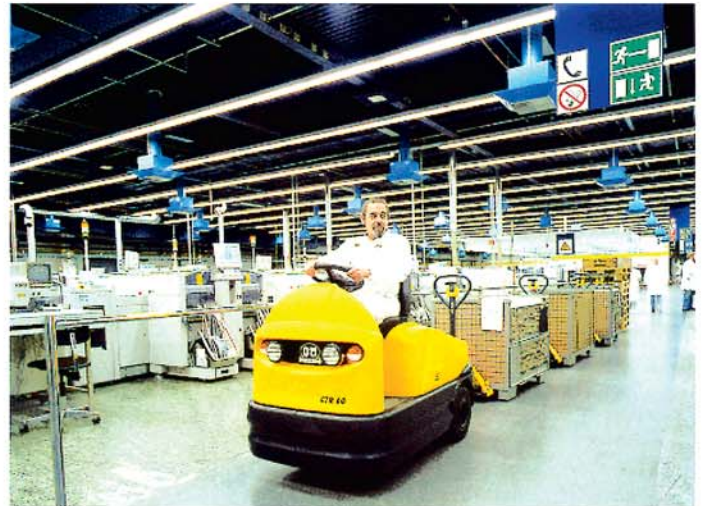
Elektroschlepper CTR mit fünf Hubwagen auf der Eil-Express-Linie
