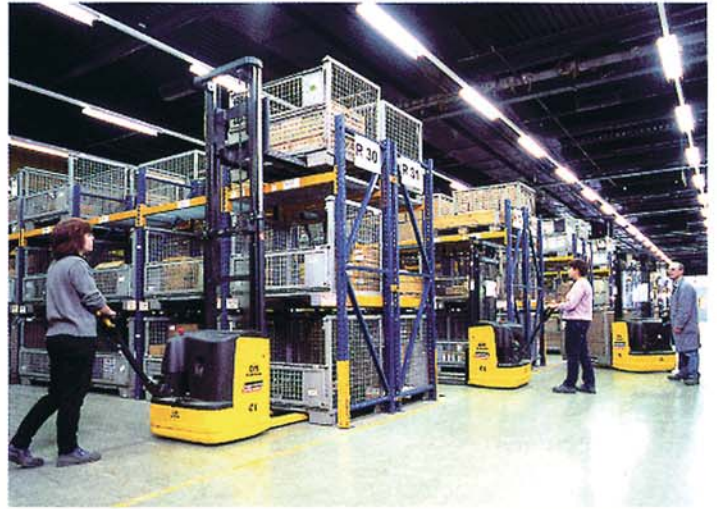
Sammeln, Verteilen und Stapeln mit dem Elektro-Deichsel-Hochhubwagen CL 12
