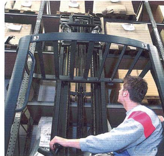
Bild 2: Bei Hubhöhen von bis zu 11,52 m ist die freie Sicht durchs Dach von besonderem Vorteil
